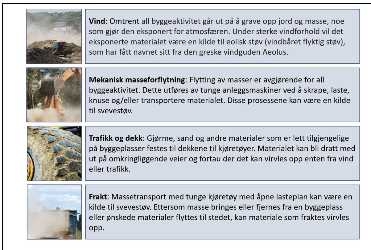
Figur 23: Prosesser knyttet til bygg- og anleggsvirksomhet som kan bidra til svevestøv-nivåene i kommunen.
